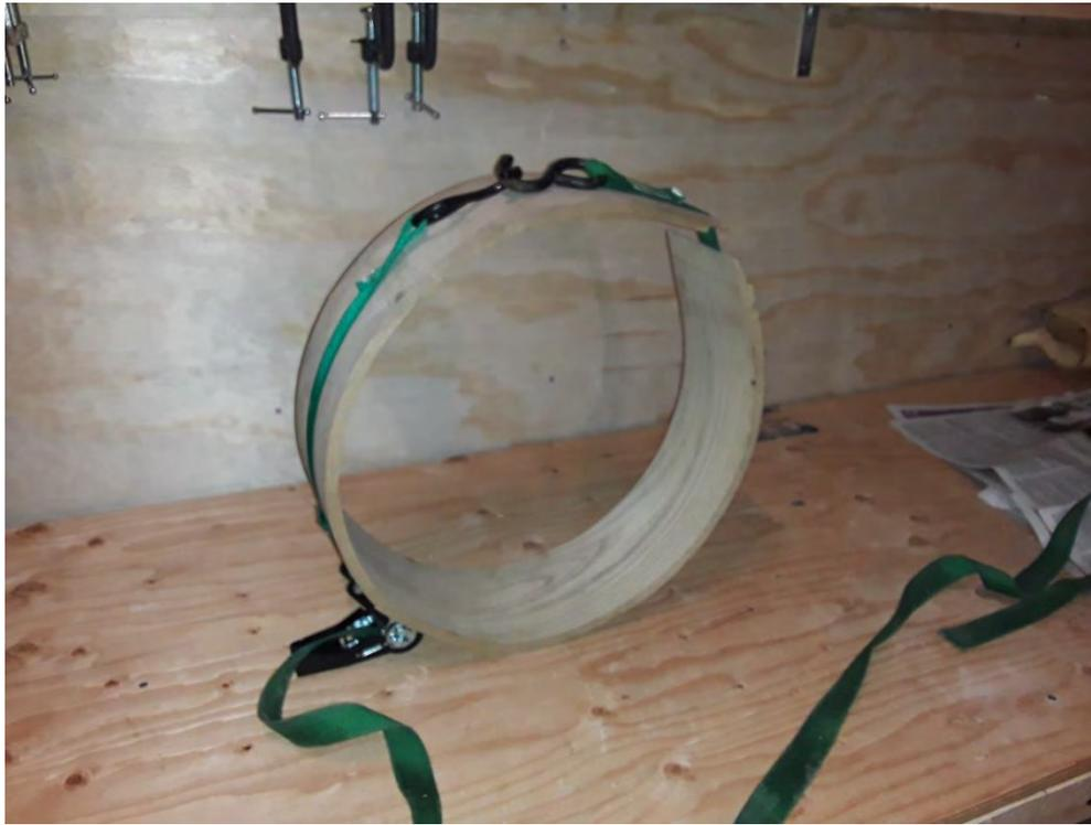
*Figure 12: Sangle à cliquet de type Bender pour resserrer lors du collage*
