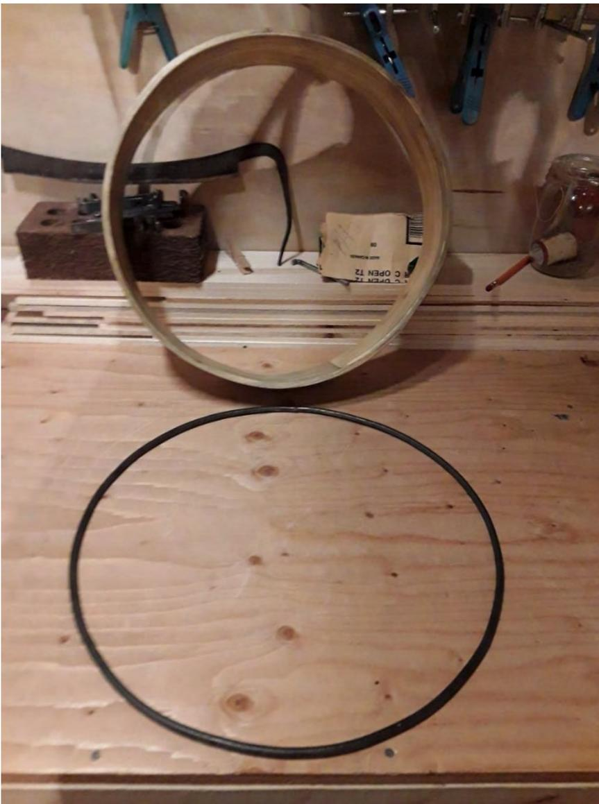
Figure 29: Cerceau de métal soudé bout à bout et fait pour ce cadre
