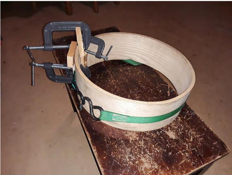
*Figure 13: Collage d'un cadre en bois de frêne et serre joints*
