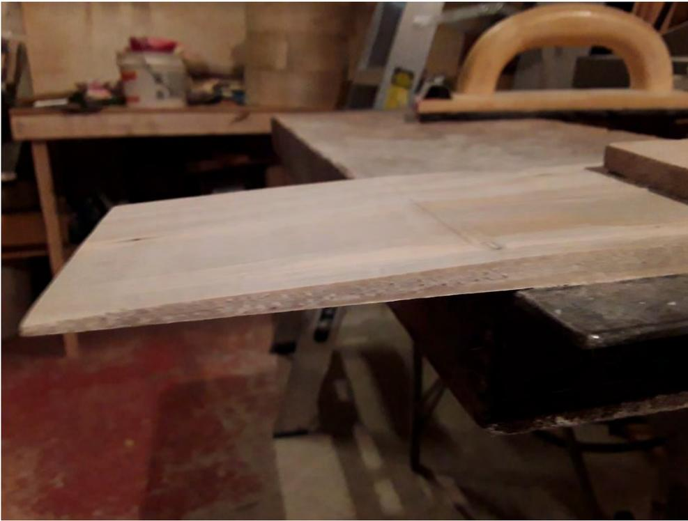
Figure 16: Formation d'un joint en biseau sur une planche de tremble
