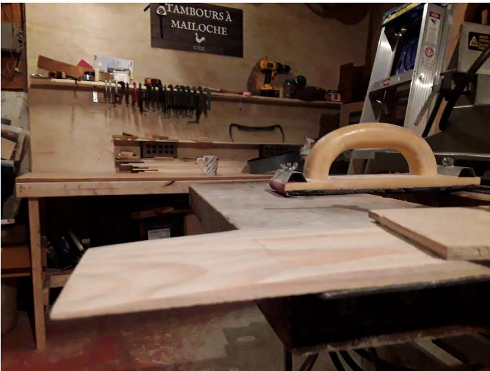
Figure 17: Sablage d'un joint en biseau sur planche de tremble
