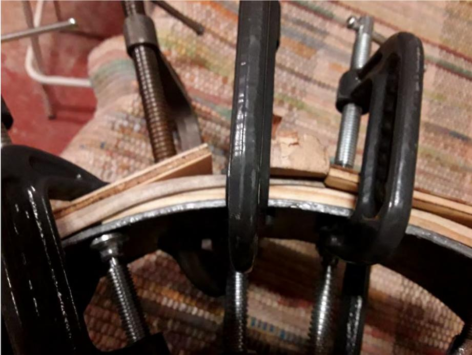
Figure 22: Joints en biseau pliés sur une planche de pin rouge
