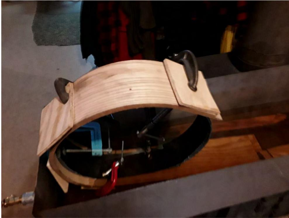
*Figure 9 : Pliage d'une planche de frêne en cours de pliage et réchauffage du bois*
