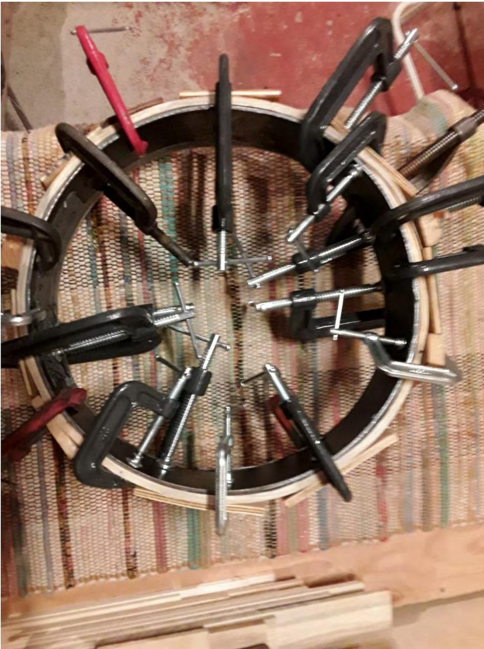
Figure 23: Planche de pin pliée au séchage
