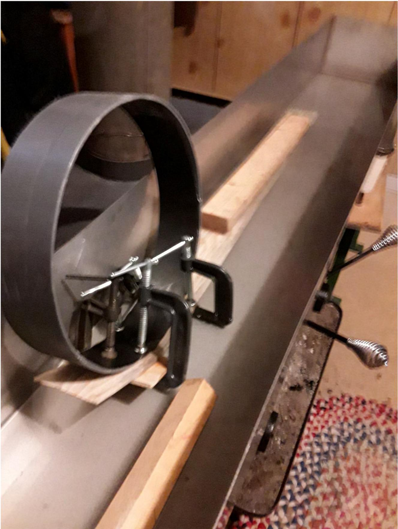
Figure 19: Début de pliage d'une planche de pin rouge
