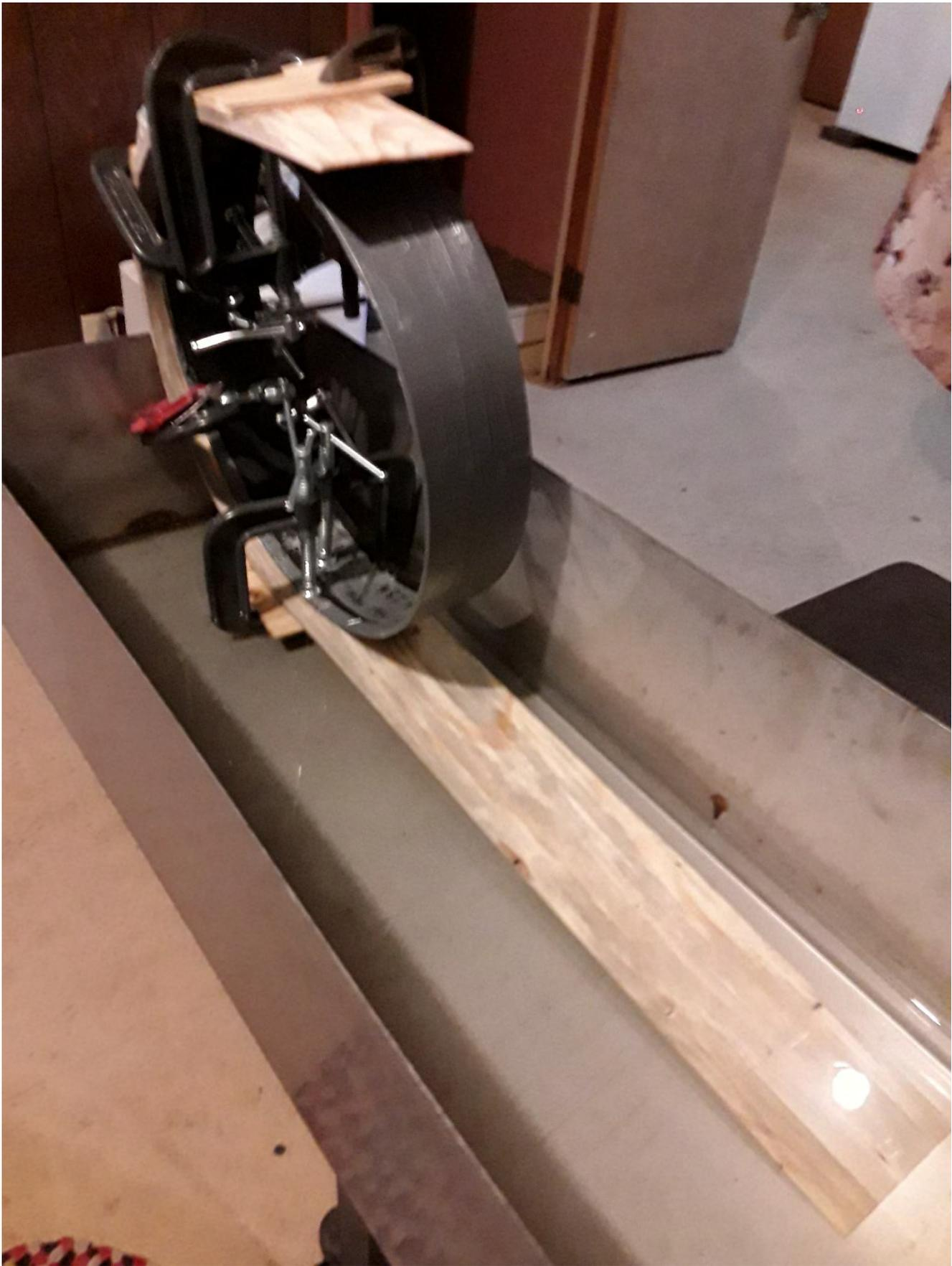
Figure 20: Pliage d'une planche de pin rouge
