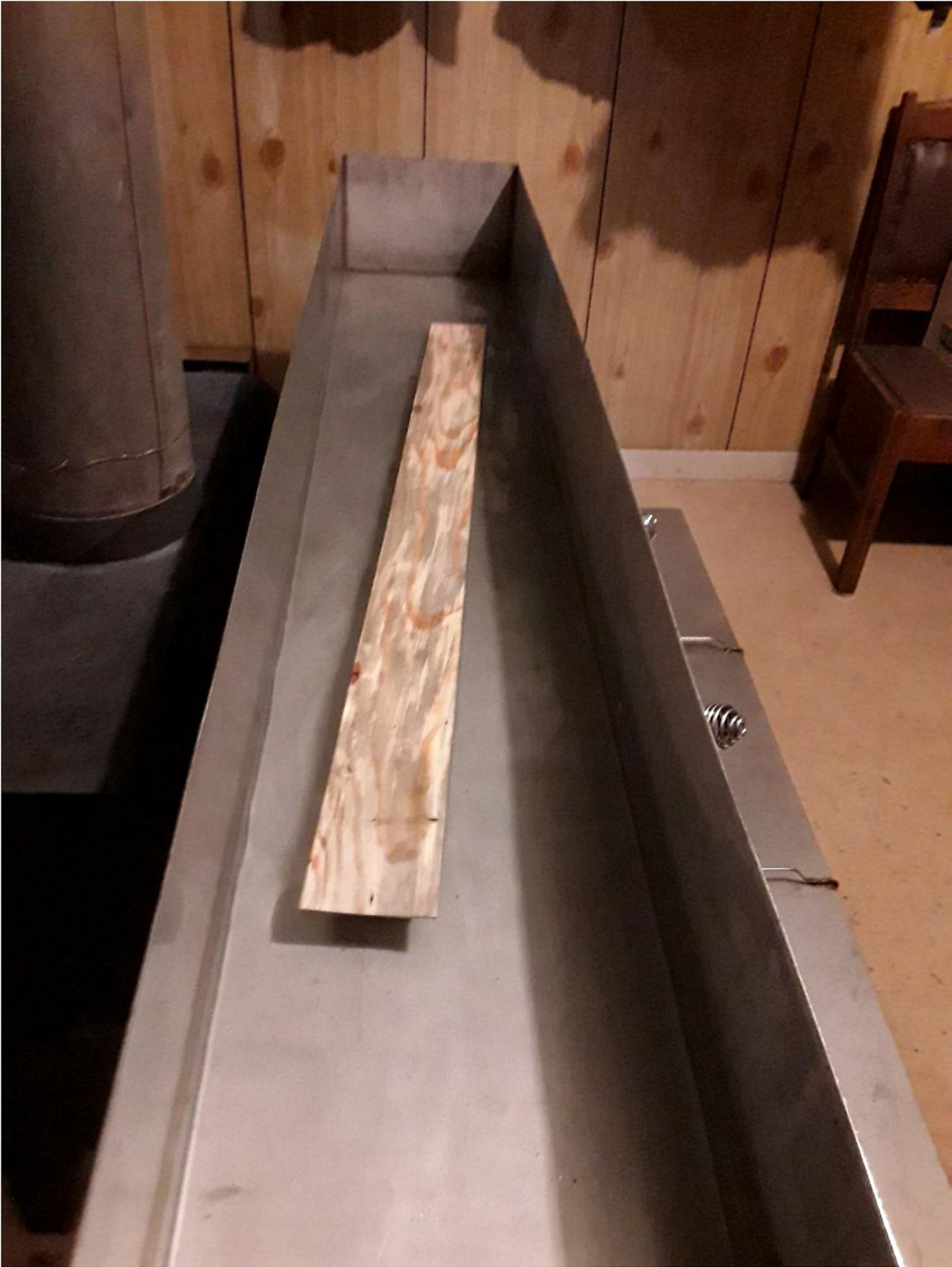
*Figure 7: Bouillage d'une planche de frêne avant pliage*
