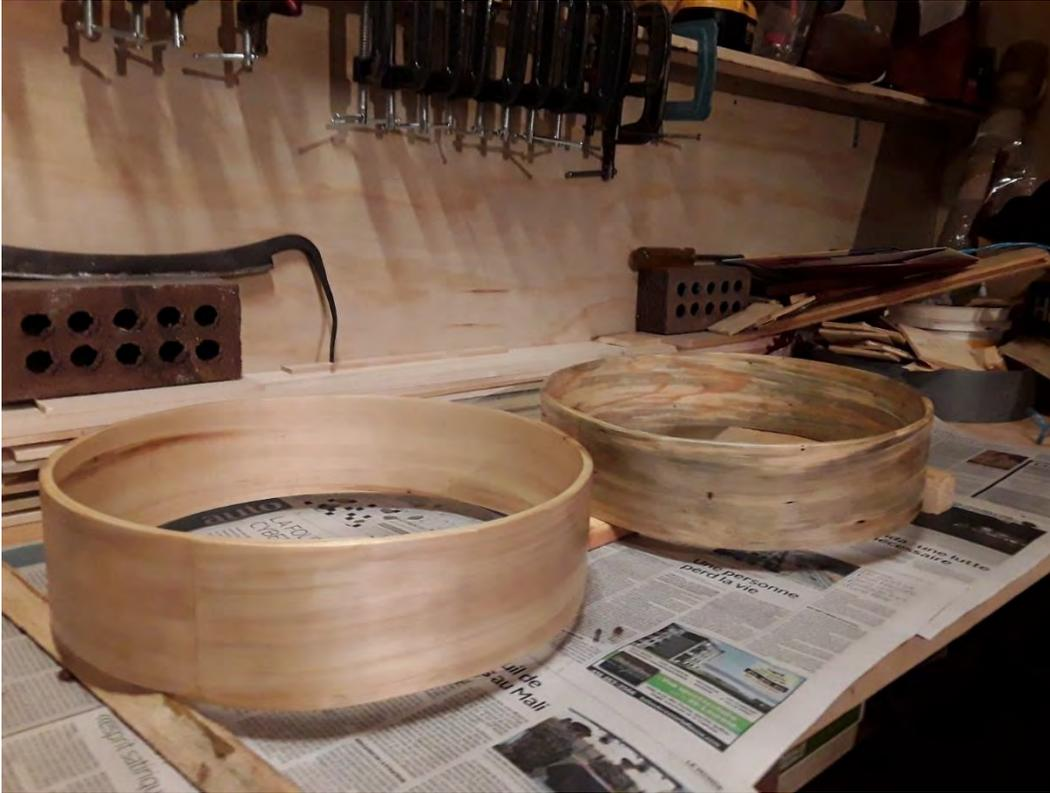
Figure 30: Cadres de tambour vernis ; en tremble (celui de gauche) et en pin rouge (celui à droite)
