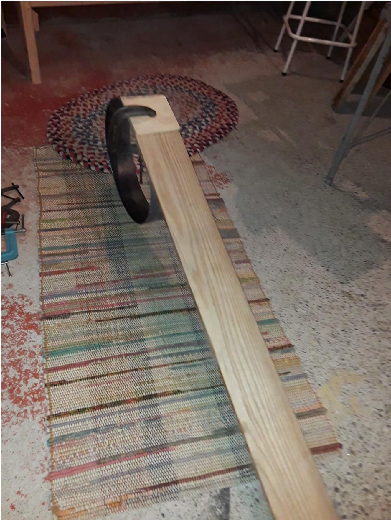
Figure 8: Début du pliage d'une planche de frêne sur moule de fer
