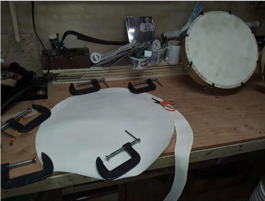
Figure 45: Découpage au ciseau en gardant une marge de 2 pouces
