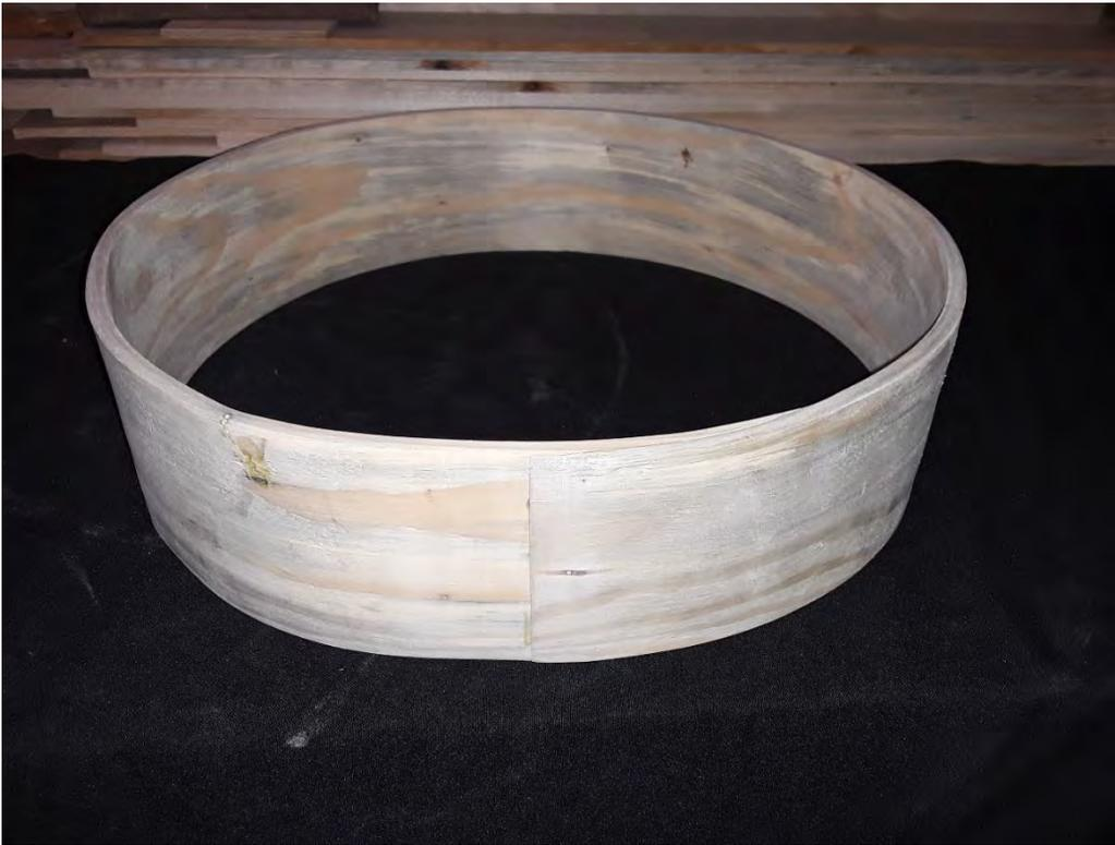
Figure 24: Cadre de tambour en pin rouge démoulé et collé
