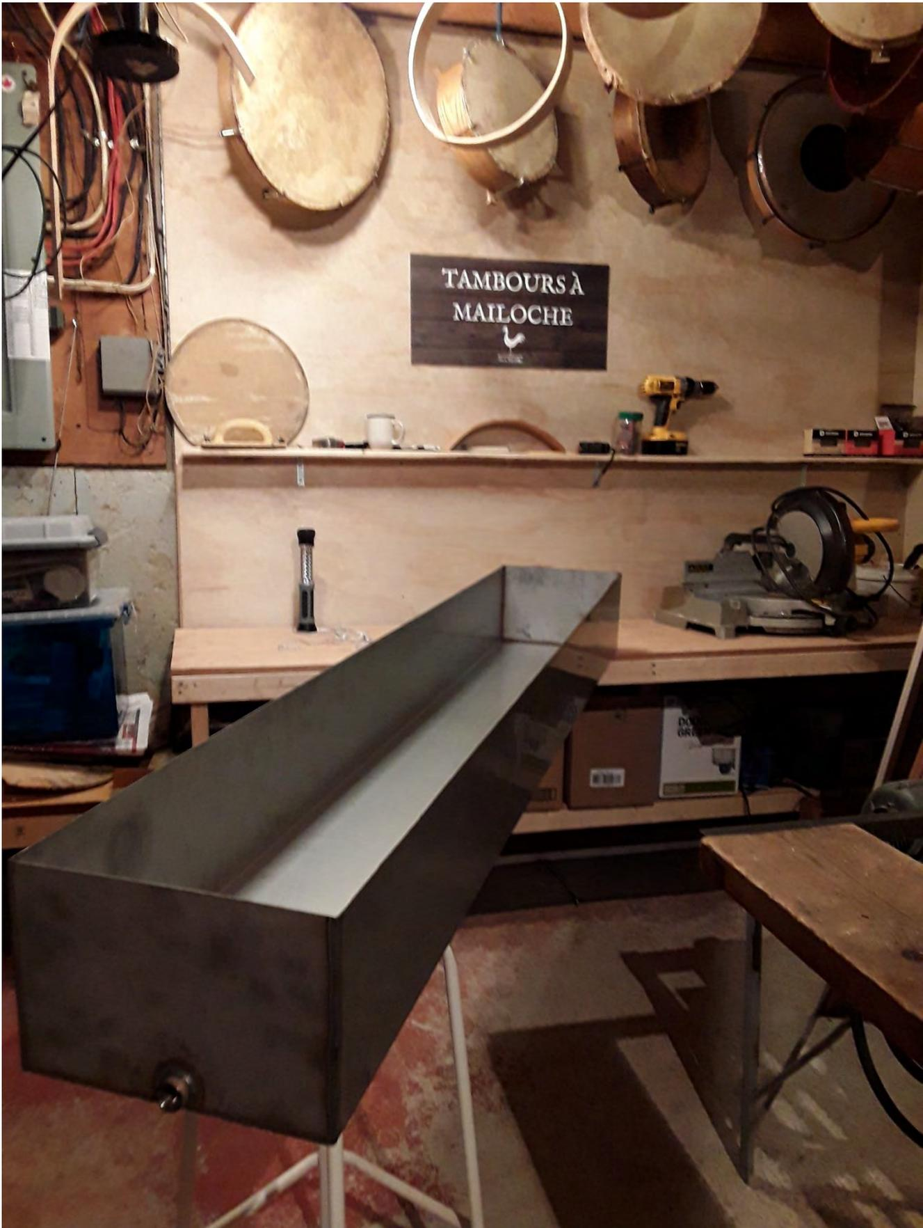
Figure 1: Panne à bouillir en acier inoxydable
