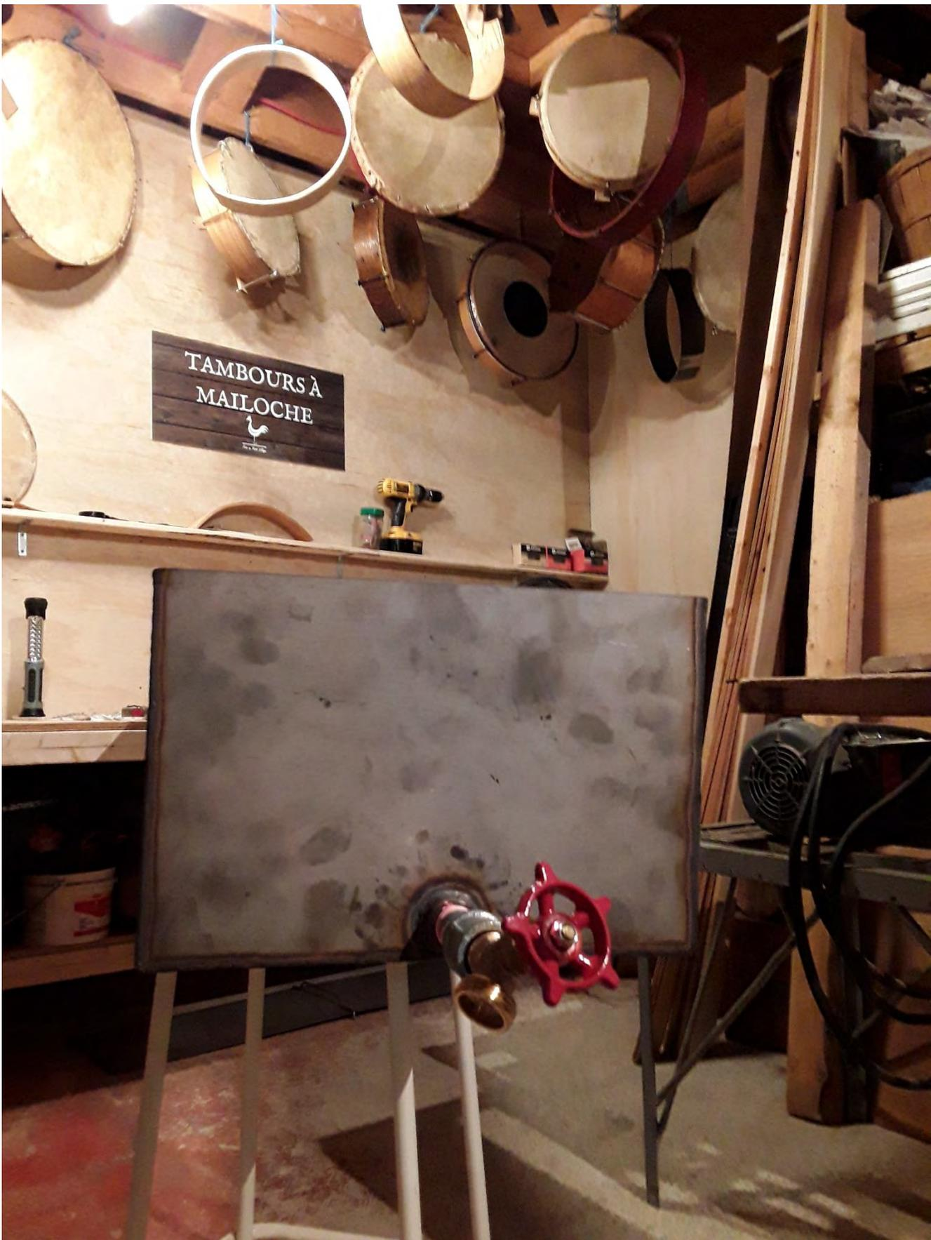
Figure 2 : Valve robinet pour évacuation de l'eau chaude
