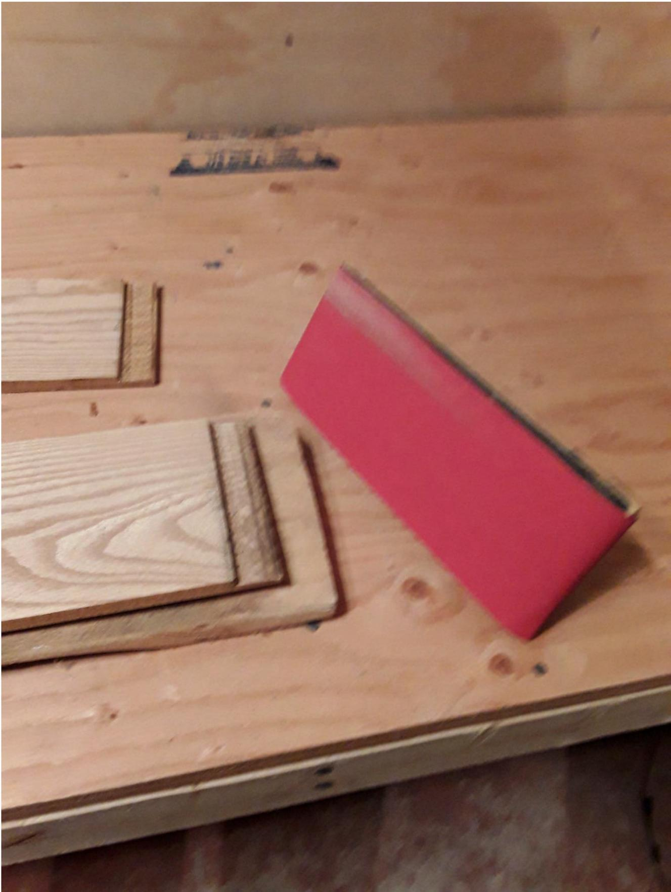
Figure 6 : Sablage d'un joint rectangulaire sur une planche de frêne
