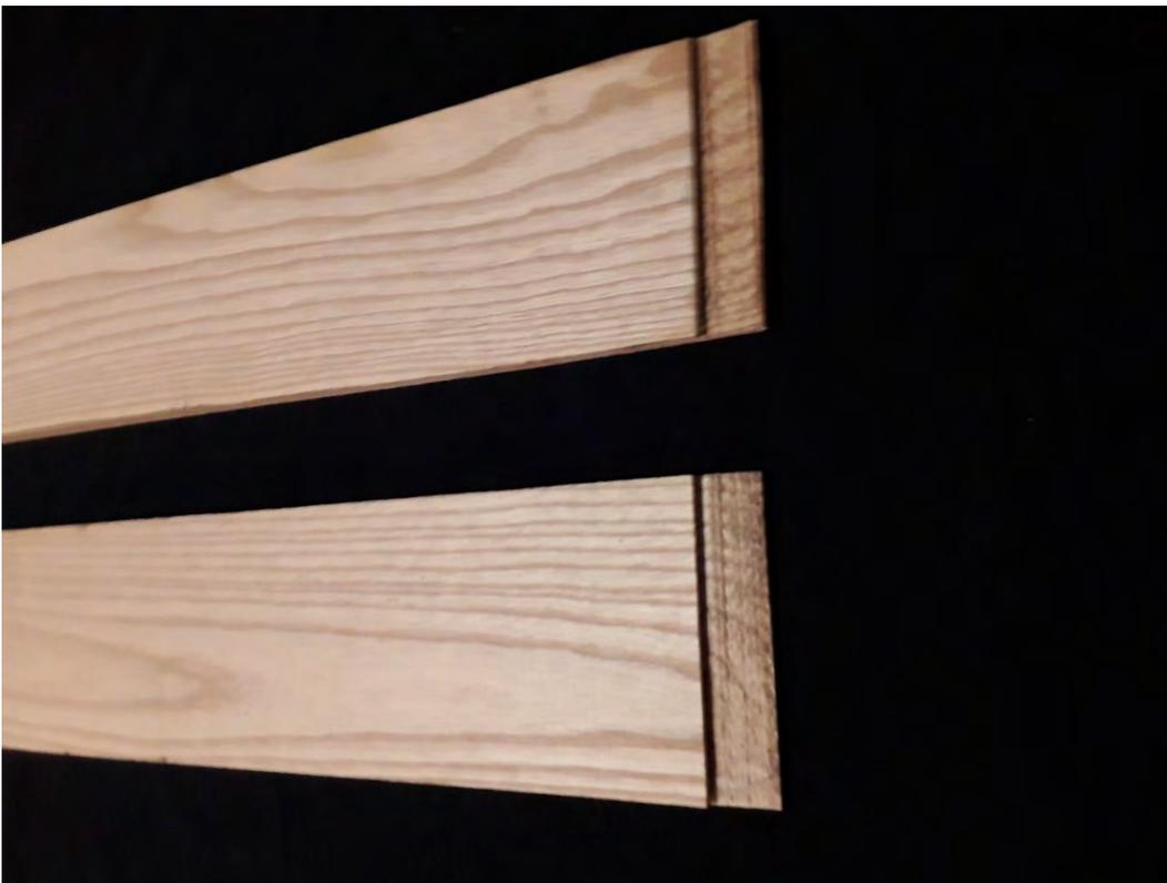
Figure 5: Joints de 1 pouce rectangulaire sur planches de frêne
