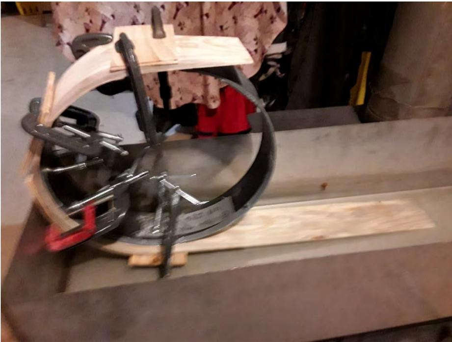
Figure 21: Pliage d'une planche de pin rouge presque terminé
