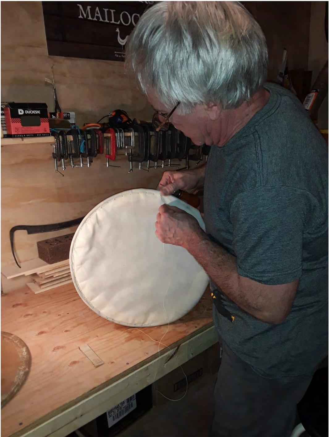
Figure 34 : Peau en cours de fixation sur le cerceau de métal
