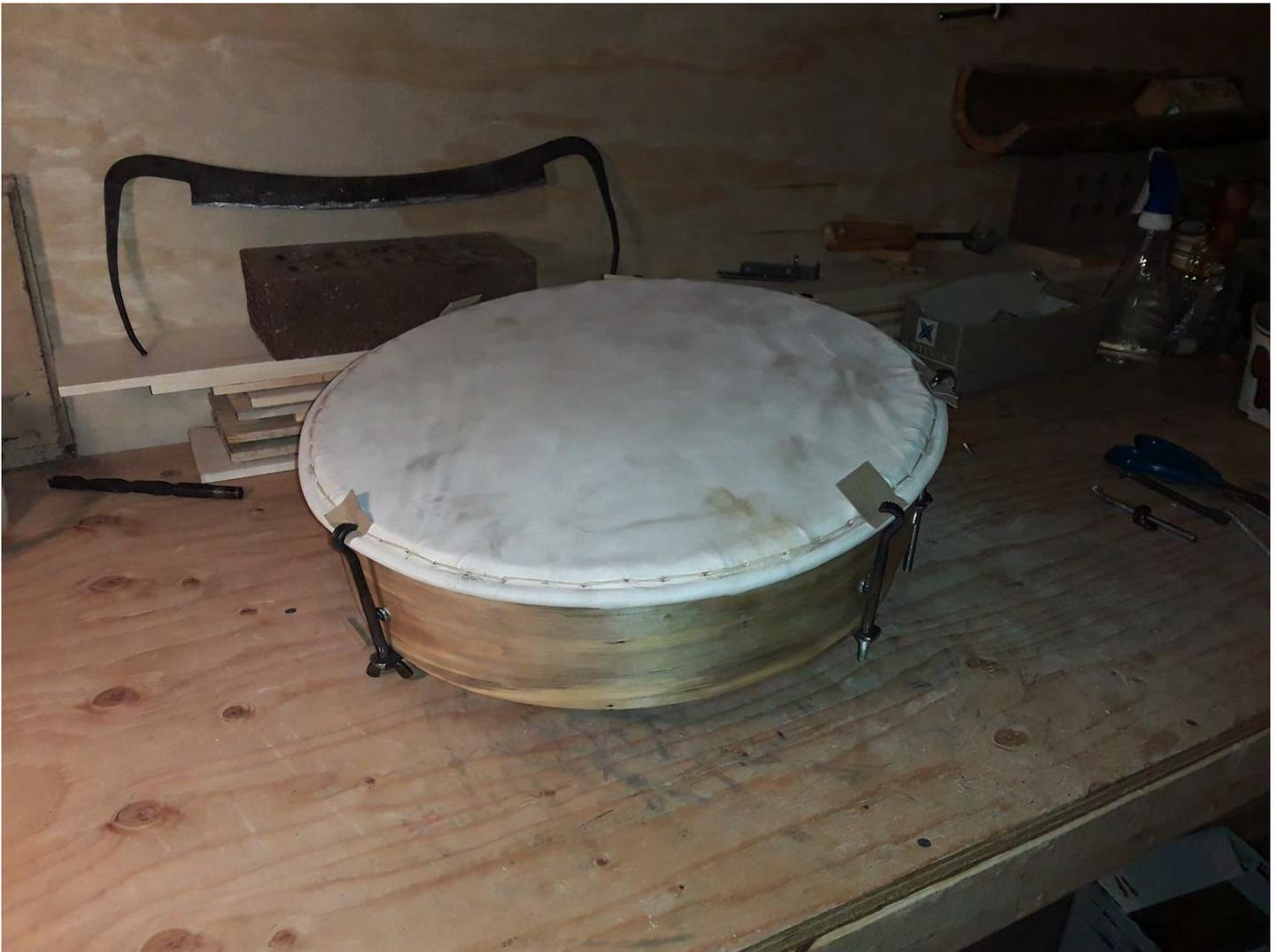
Figure 39: Crochets de métal installés sur le tambour
