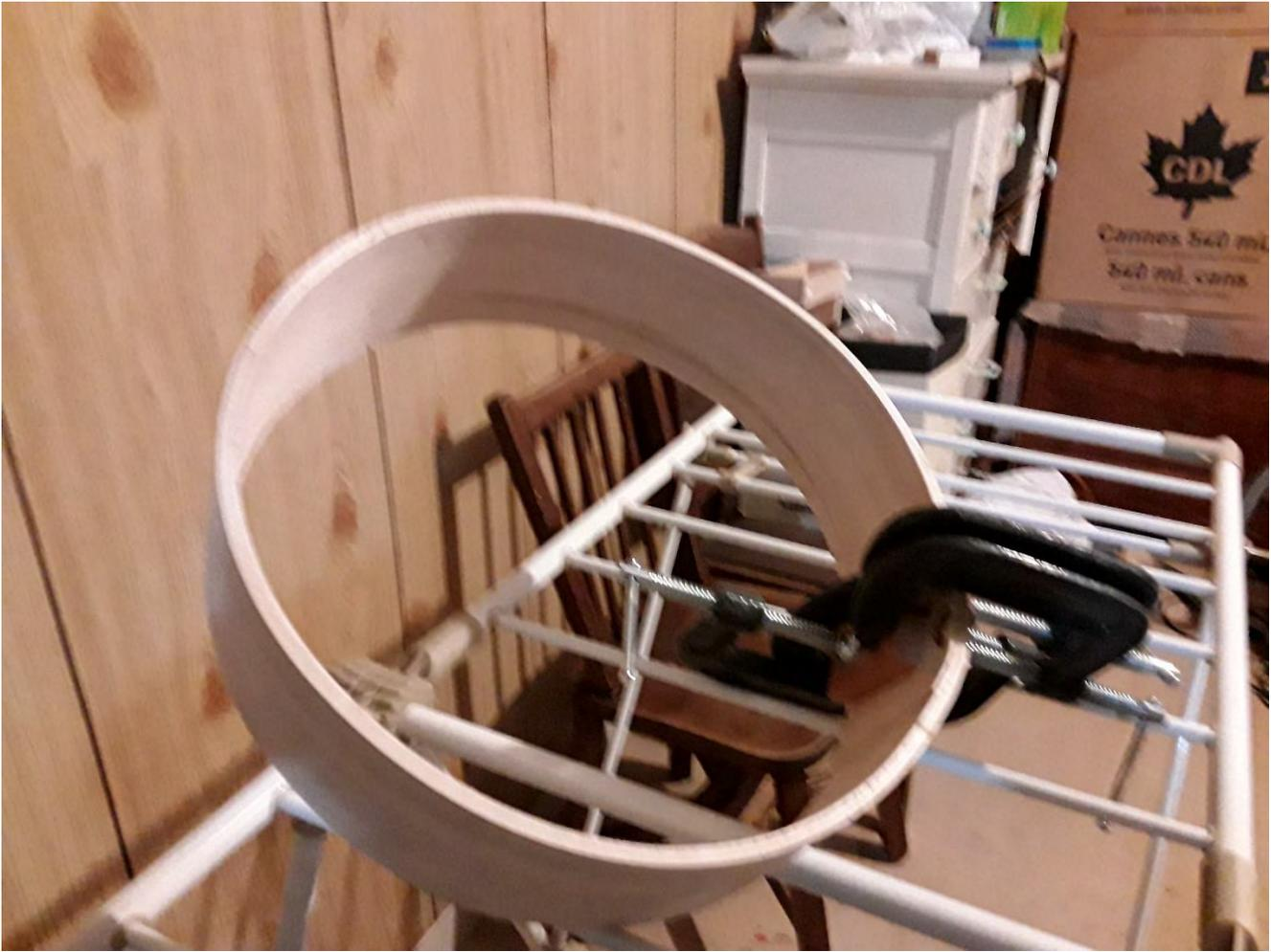
Figure 26: Cadre de tambour en tremble au collage avec serre joint
