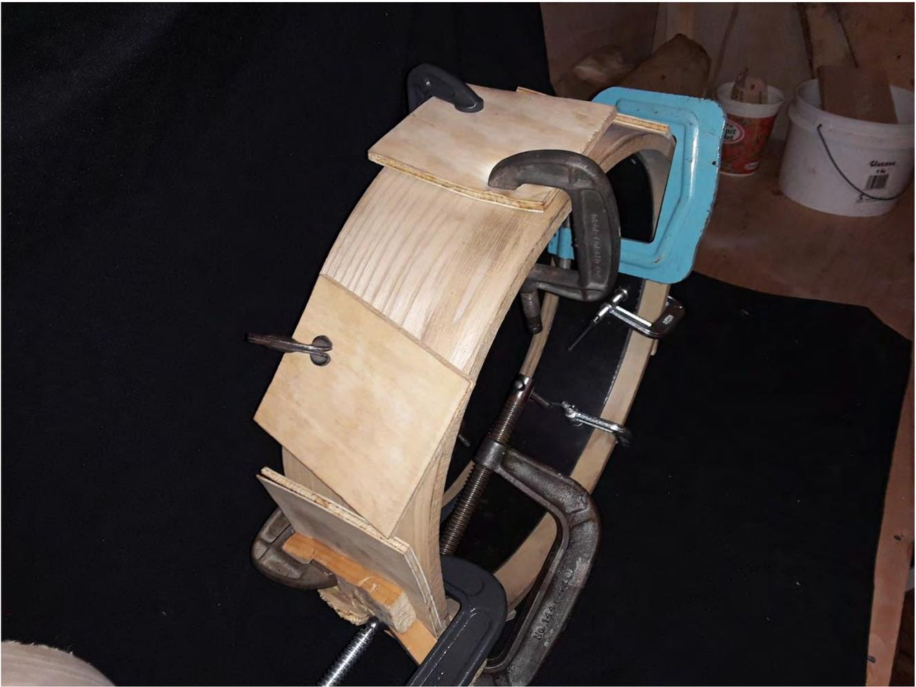
Figure 11: Pliage complet et protection sous serres sur un cadre en frêne
